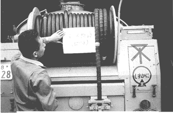
写真 7 高圧ホースのピッチ防護
