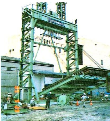
写真-12 鉄筋かご建込み機
