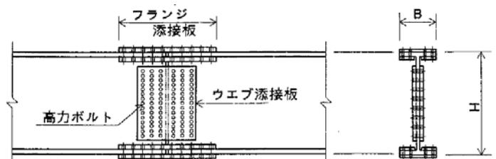
図-5 高力ボルト摩擦接合継手図
