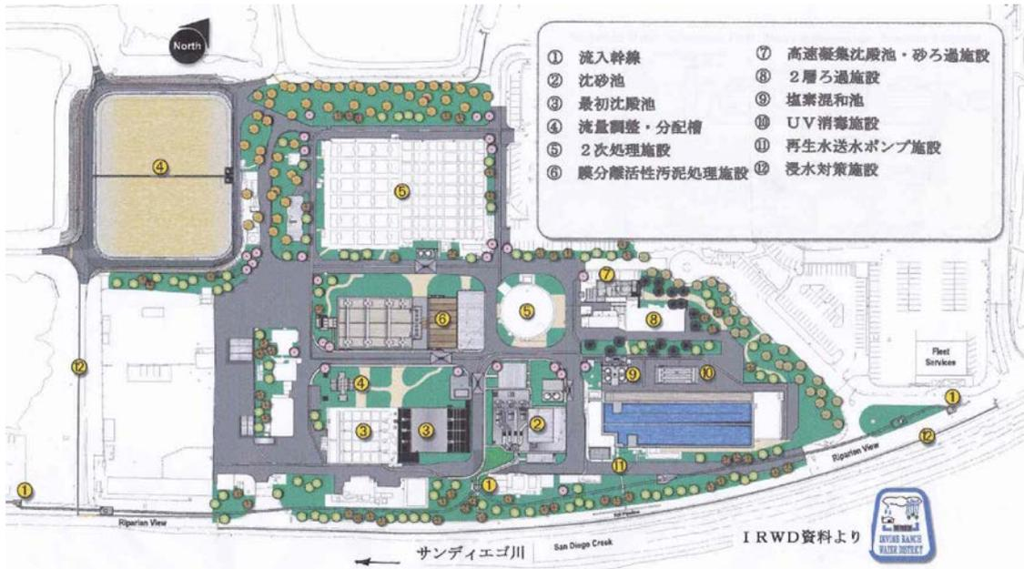
図-15 ミカエルソン水再生処理場の平面図
